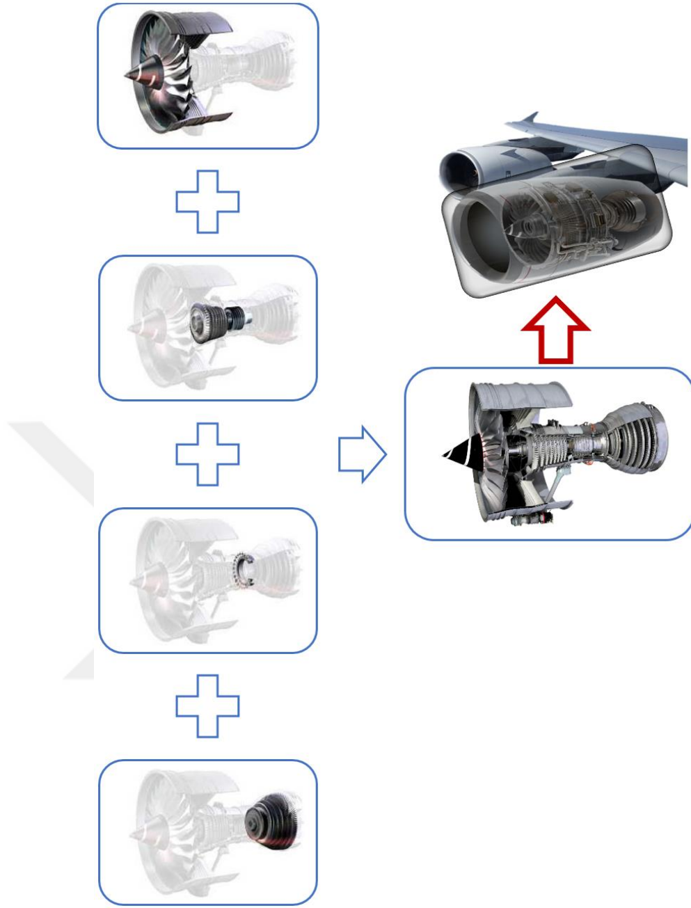
Şekil 3.2. Turbofan motora ait parçaların tek ve montaj şeklinde gösterimi [68]
