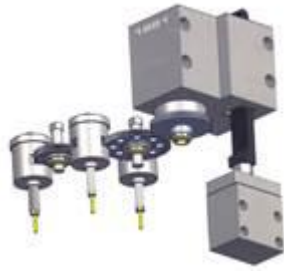
Şekil 38. Mekanik Klavuz Çekme
