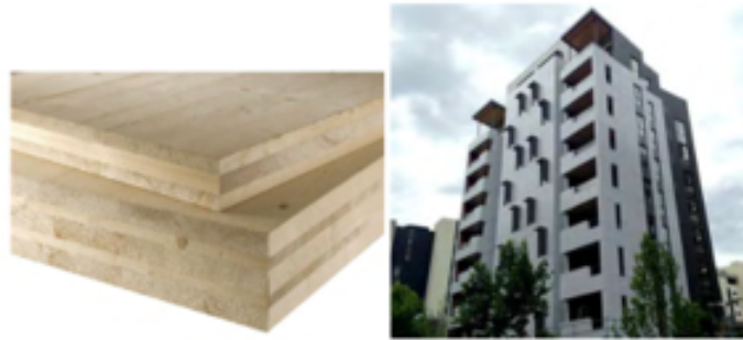
Şekil 2.29 CLT panel ve dış duvarları CLT panellerden oluşturulmuş bir yapı örneği [20]
