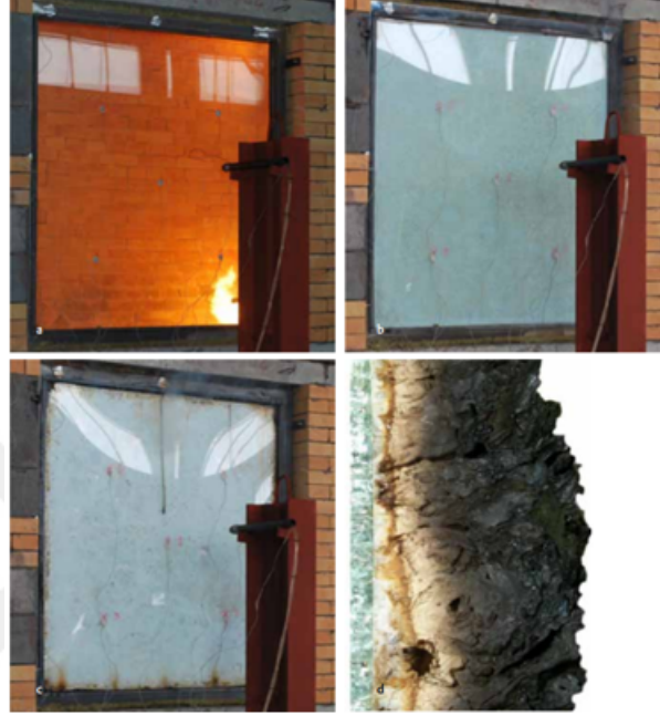
Şekil 2.57 6 mm kalınlığındaki Aerosil dolgulu EI 30 (30 dk) yangın direnimli cam panelin yanma testi sırasında geçirdiği aşamalar a)1 dk, b) 20 dk c) 35 dk d) ara katmanı gösteren malzeme kesidi (cam panelin yangına karşı direnime göstermesi) [171]
