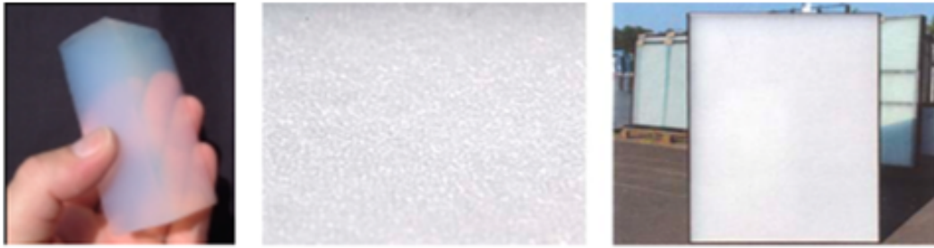
Şekil 2.51 Aerojel ve Aerojel katkılı ısı yalıtım paneli [25]
