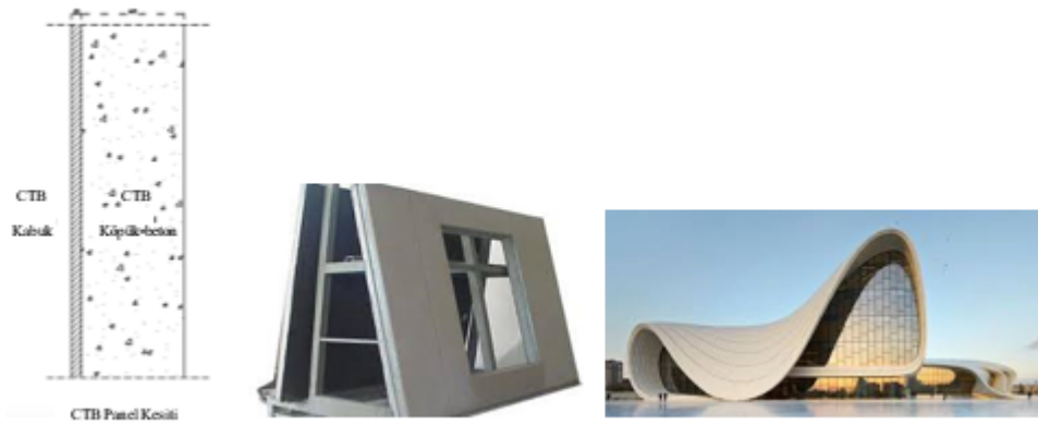
Şekil 2.37 Cam elyaf katkılı hafif prekast paneller ve yapıda uygulama örneği/ Bakü, Haydar Aliyev Kültür Merkezi [117–119]
