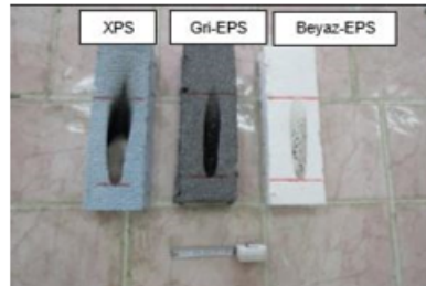
Şekil 2.42 Deneyde kullanılacak olan yalıtım malzemelerinin yanıcılık özelliklerinin belirlenmesi [129]
