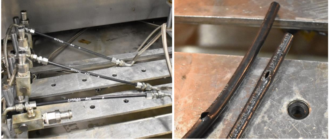
Şekil 5.20 : Sıcak patlatma testinin uygulanışı.
