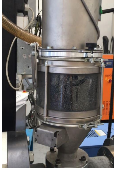
Şekil 5.3 : Ekstrüder besleme hunisi.
