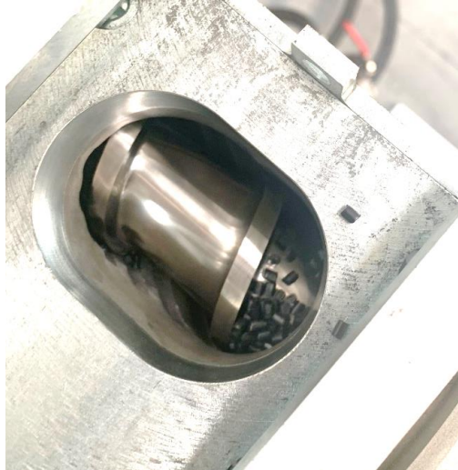
Şekil 5.4 : Ekstrüder vidasının besleme bölgesi.
