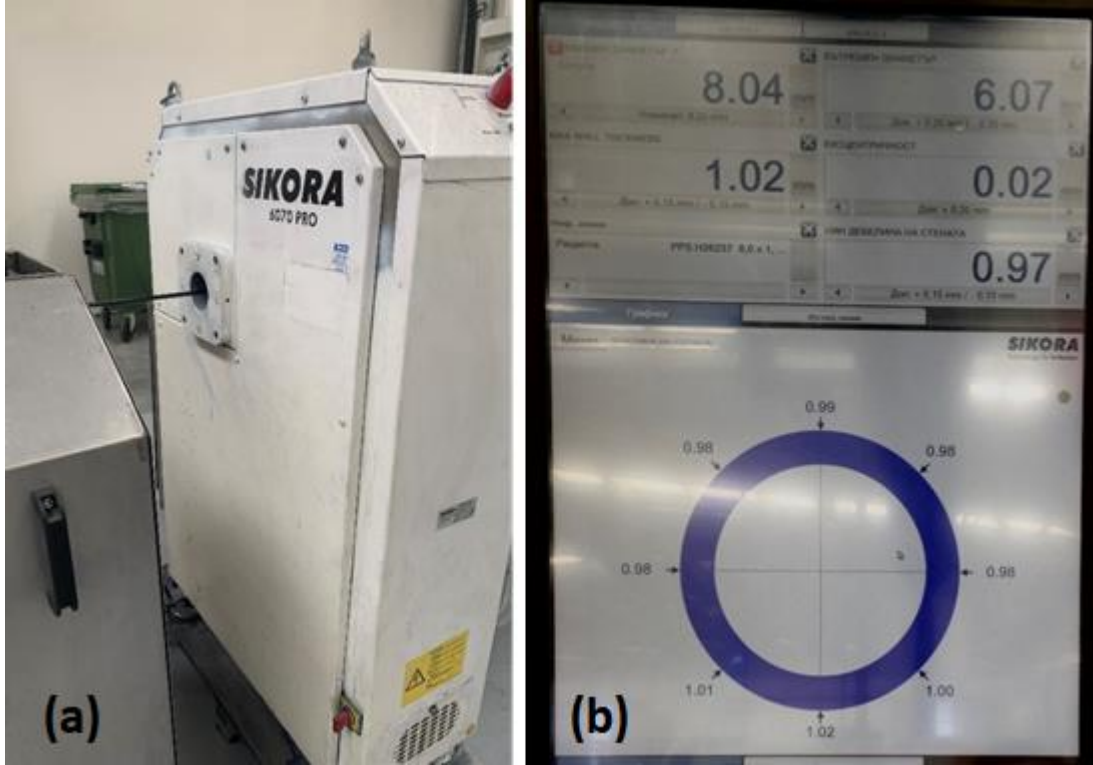
Şekil 5.9 : SIKORA x-ışını ölçüm cihazı (a) ve ölçüm işlemi (b).
