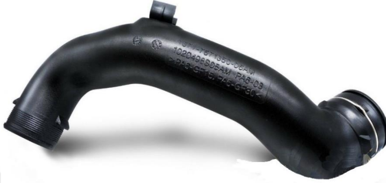
Şekil 1.1 : PA6 malzemesinden üretilen turbo borusu [5].
