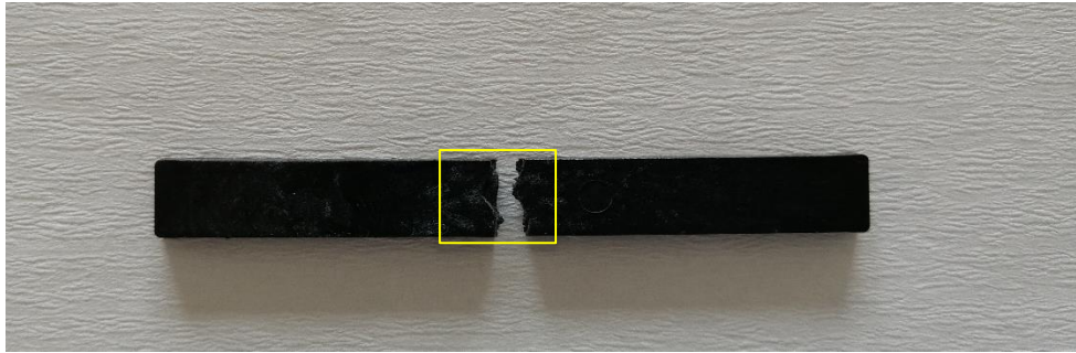
Şekil 7.6. PA66 %30 cam elyafli ağırlıkça %0,4 MWCNT- COOH içeren çekme ve eğme numunelerin test sonrası deförme görüntüleri.
