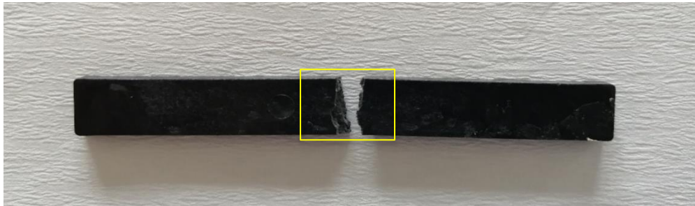
Şekil 7.8. PA66 %30 cam elyafı ağırlıkça %0,2 hBN ve %0,2 MWCNT- COOH içeren çekme ve eğme numunelerin test sonrası deförme görüntüleri.
