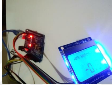
Şekil 5.25. LCD Ekran mikro denetleyici kart bağlantısı
