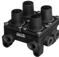
Şekil 3.8. Dört yollu emniyet valfi ve iç yapısı (Tüvtürk, 2016)
