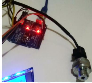
Şekil 5.21. Basınç sensörü arduino bağlantısı
