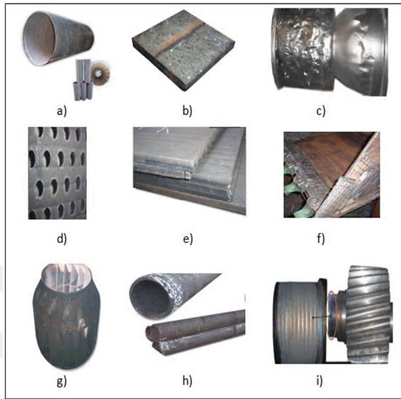
Şekil 2.4. Sert dolgu kaynağı uygulanmış makine parçalarının resimleri. a) Çimento fabrikalarının öğütme tesislerinde kullanılan aşınmaya dayanıklı boruların sert dolgu kaynağı uygulaması. b) Aşınma plakası. c) Kumlama makinelerinde kullanılan rölelere uygulanmış sert dolgu kaynağı. d) İşlenmiş aşınma plakası. e) Aşınma plakaları. f) İş makinası kepçesine uygulanmış sert dolgu kaynağı g) Aşınma plakalarından elde edilen fan kanadının sert dolgu kaynağı uygulaması. h) Kumlama makinelerinde kullanılan rölelerin sert dolgu kaynağı uygulaması. i) Adezyon aşınması sonucu aşınmış milin sert dolgu kaynağı uygulaması [35].
