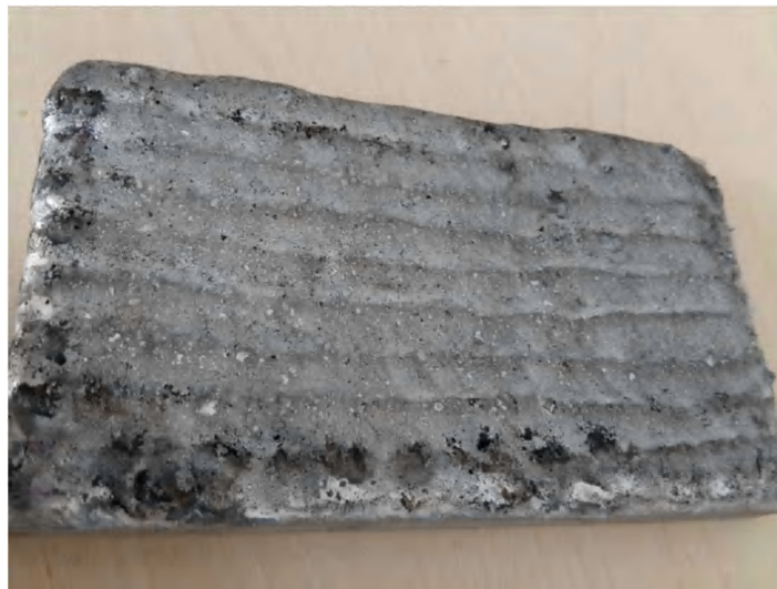
Şekil 3.11. Yüzey dolgusu yapılmış plaka.
