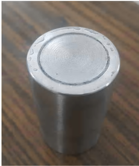
Şekil 3.5. İçine toz sıkıştırılmış bilet.
