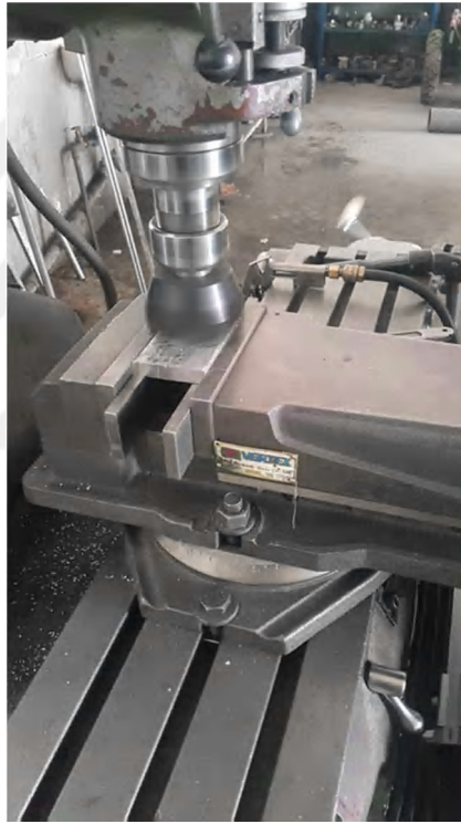
Şekil 3.12. Dolgu kaynağı yapılmış plakaların yüzeyinin silinmesi.
