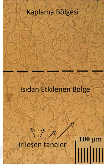
Şekil 4.9. Al dolgu çubuğuyla yapılan yüzey kaplamasının ve ısıdan etkilenmiş bölgenin iç yapı görüntüsü.
