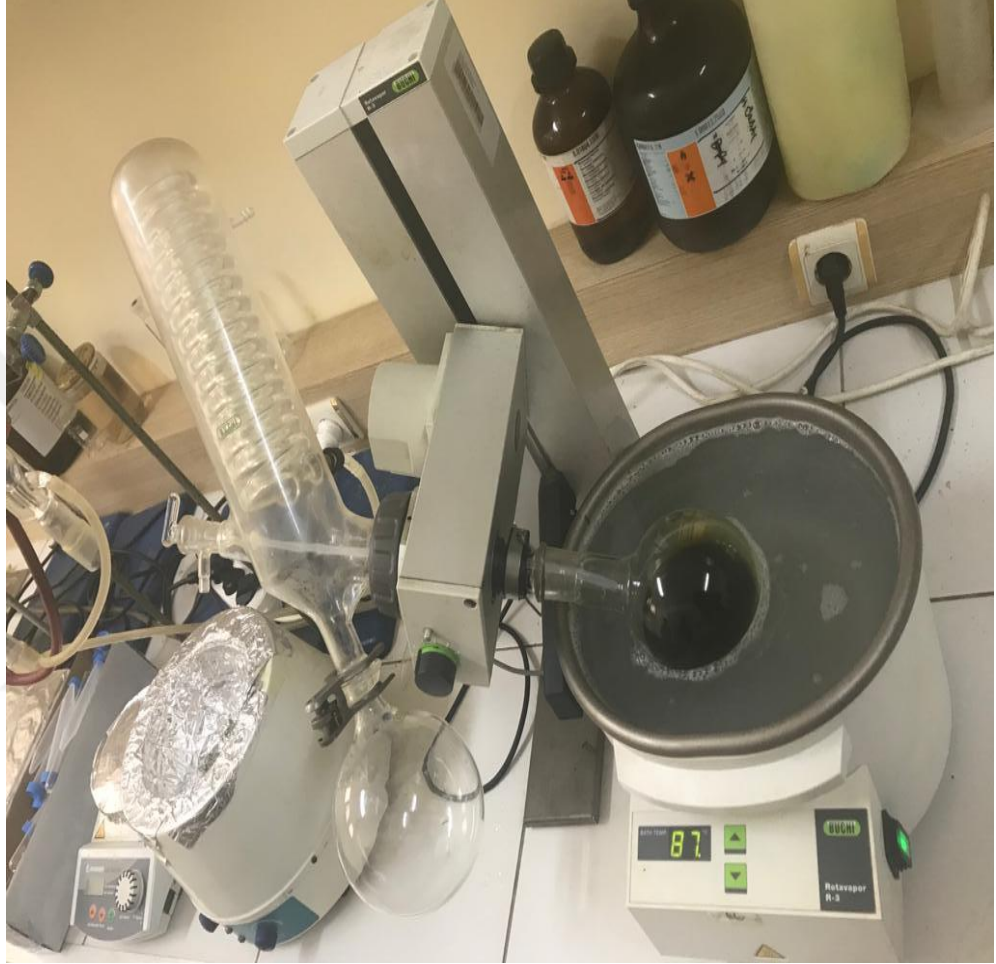
Resim 11: Evaporatör cihazında uçurma işlemi
