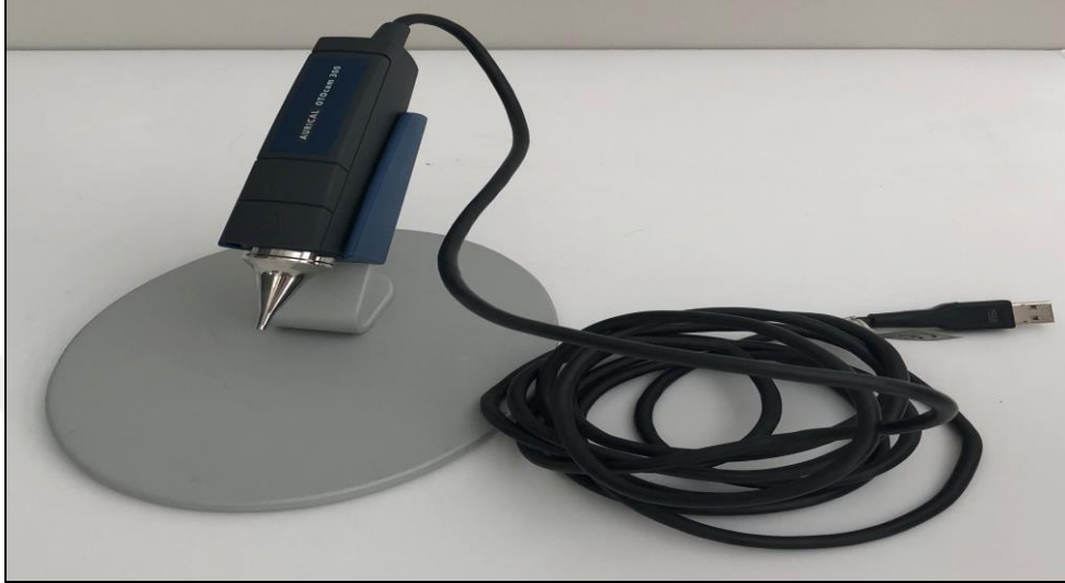
Şekil 3-4: Video-otoskop cihazı (otometrics-Denmark).
