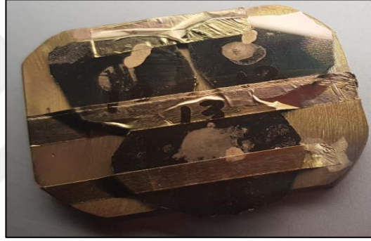
Şekil 4.12. SEM analizi için numunelerin yüzeyi altın kaplanarak hazırlanması
