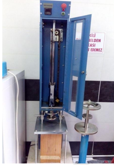
Şekil 3.16 Marshall sıkıştırma tokmağı
