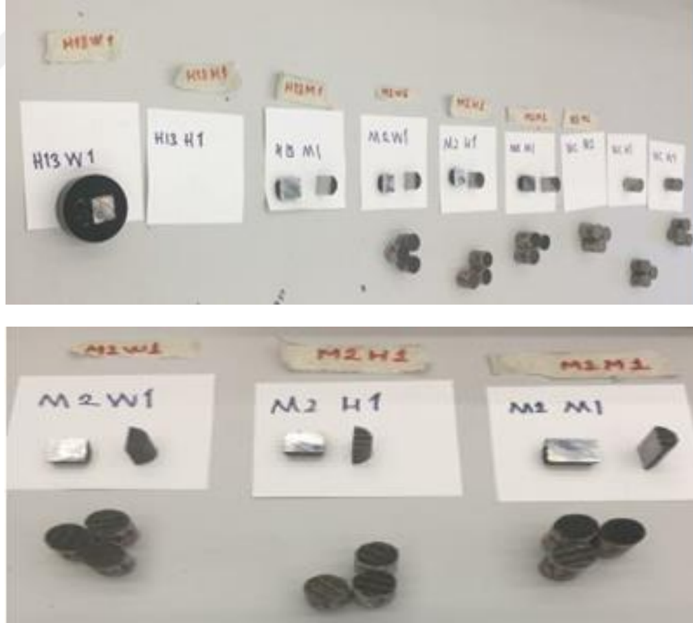
Ek 6: Mikro Yapı İncelemelerine Uygun Boyutlara Getirilen ve Gruplandırılan Parçalar.
