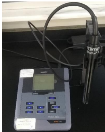
Şekil 3.3 : İletkenlik ölçer (WTW Inolab Cond 3710).
