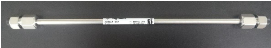
Şekil 3.9 : Şeker bileşenleri analizinde kullanılan NH 2 analitik kolonu.
