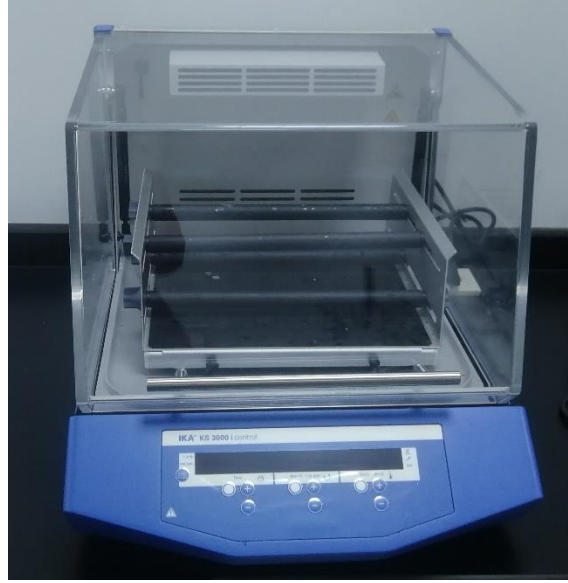
Şekil 3.8 : Yatay salınlı çalkalayıcı (IKA KS 3000İ Control).
