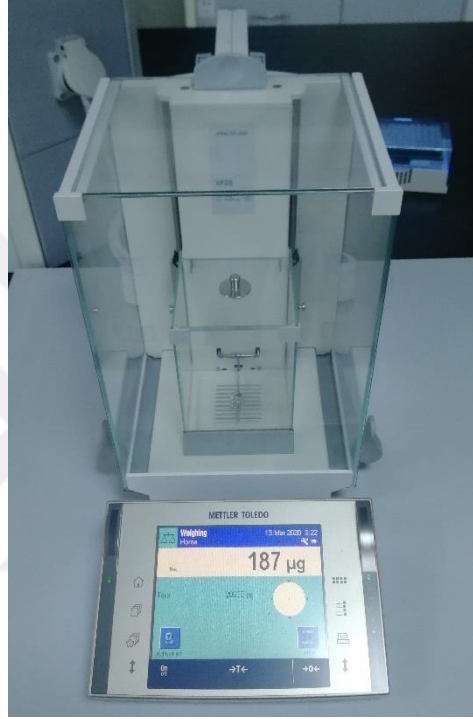
Şekil 3.15 : Mettler Toledo marka XP26 model ultra hassas terazi.
