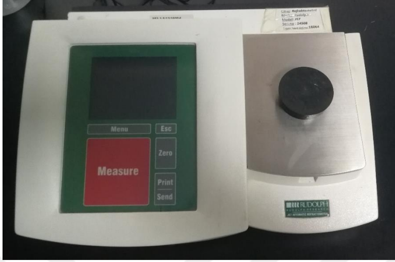
Şekil 3.2 : Masa tipi otomatik refraktometre (Rudolph Research J57).
