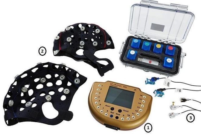
Şekil 2: Örnek bir EEG seti. 1. Elektriksel sinyal güçlendirici, 2. Başlık, 3. Elektrotlar numaralandırılmış olarak gösterilmektedir.
