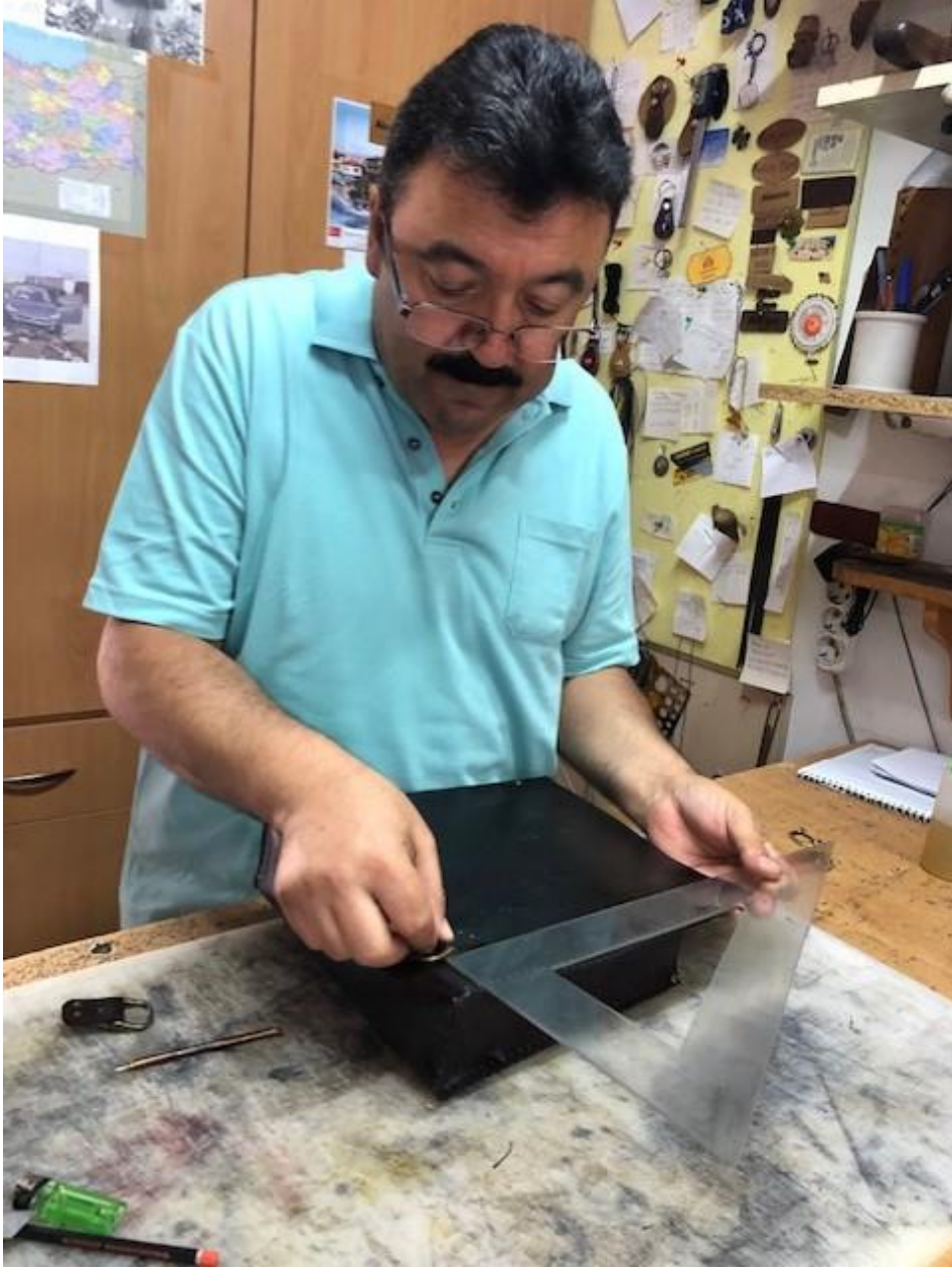
Resim 4.33. Arka tokaların takılması
