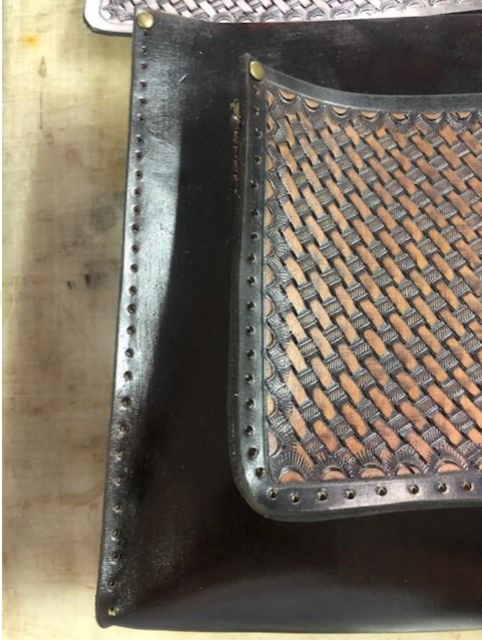
Resim 4.28. arklı zımba ile deldikten sonraki hali
