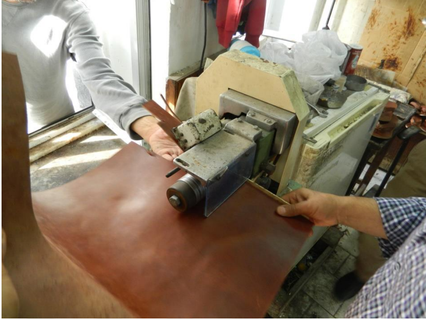
Resim 2.39. Derinin İnceltilmesi (Tıraşlama)
