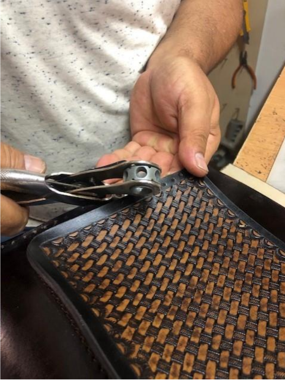
Resim 4.27. arklı zımba ile delme işlemi
