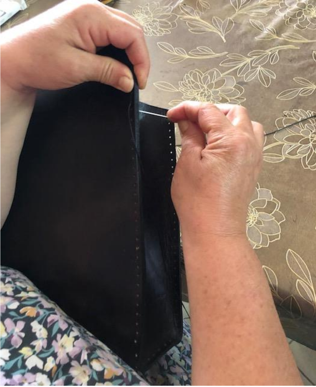
Resim 4.29. Çantayı sırim iple dikme işlemi
