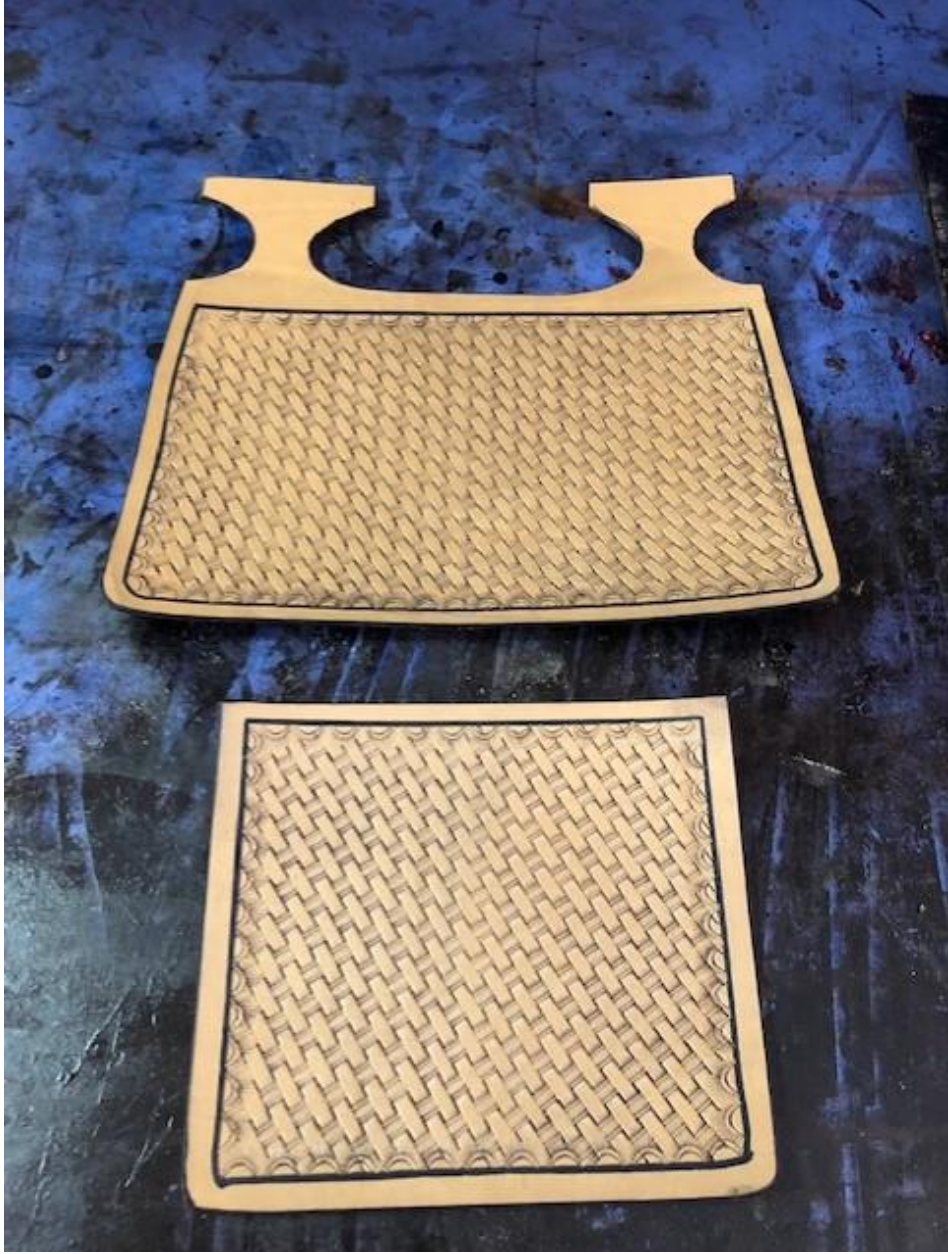
Resim 4.6. Köseleye kraft yapılmış hali
