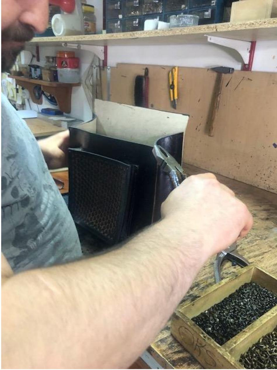
Resim 4.26. Fermejüple çantayı tutturma
