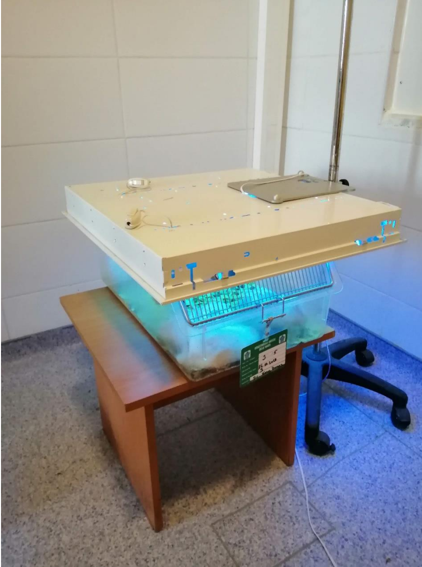
Resim-3: Yükseklik ayarlı, kombine 2 adet UVA ve 2 adet UVB lambasıyla donatılmış düzenek.
