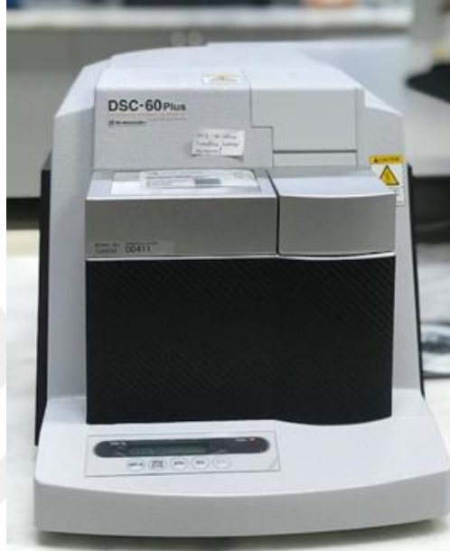
Şekil 3.7 Diferansiyel tarama kalorimetre cihazı (DSC-60 Plus, Shimadzu, Japonya)
