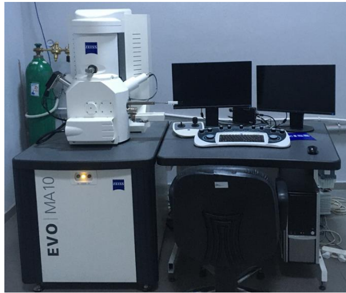
Şekil 3.4 Taramalı elektron mikroskobu (SEM) (MA-EVO10, ZEISS, Almanya)
