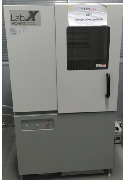
Şekil 3.8 X-ışını kırınımı cihazı (Shimadzu – 6100, Japonya)
