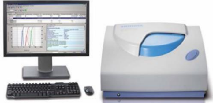
Şekil 3.3 BFO partikül boyutu ölçümünde kullanılan cihaz (Partica SZ-100Z, ABD)
