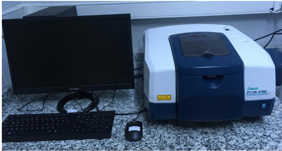
Şekil 3.6 Fourier Dönüşümlü Kızılötesi Spektroskopisi cihazı (JASCO, FT/IR-4700, Japonya)
