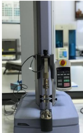
Şekil 3.9 Çekme cihazı (EZ-LX, Shimadzu, Japonya)
