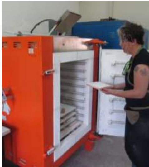
Foto 99: Pano parçalarının sır pişirimi için fırına yerleştirilmesi
