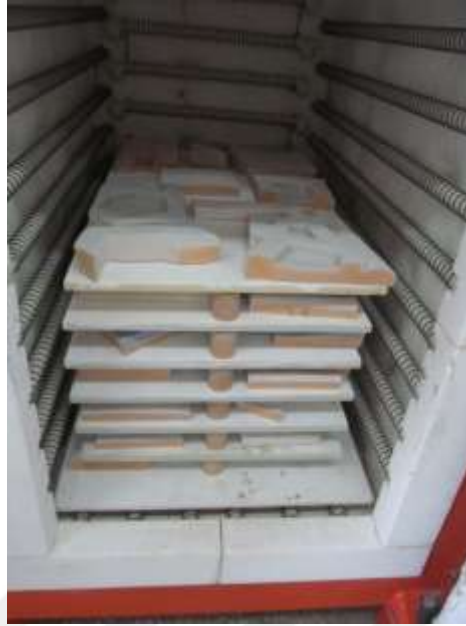
Foto 100. Sır pişirimi için yerleştirilen parçaların fırın içi genel görünüm
