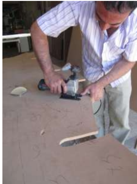
Foto 108: Suntanın şablona göre dekupaj ile kesilmesi
