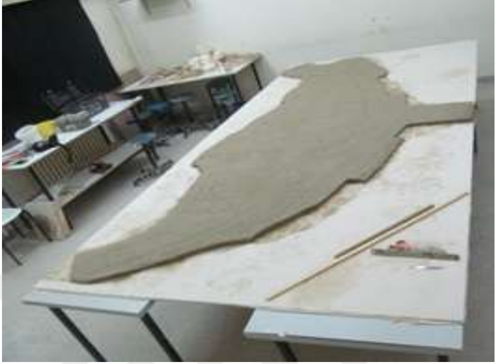
Foto 17: Çizimin ölçülerinde pano plakasının kesilmesi
