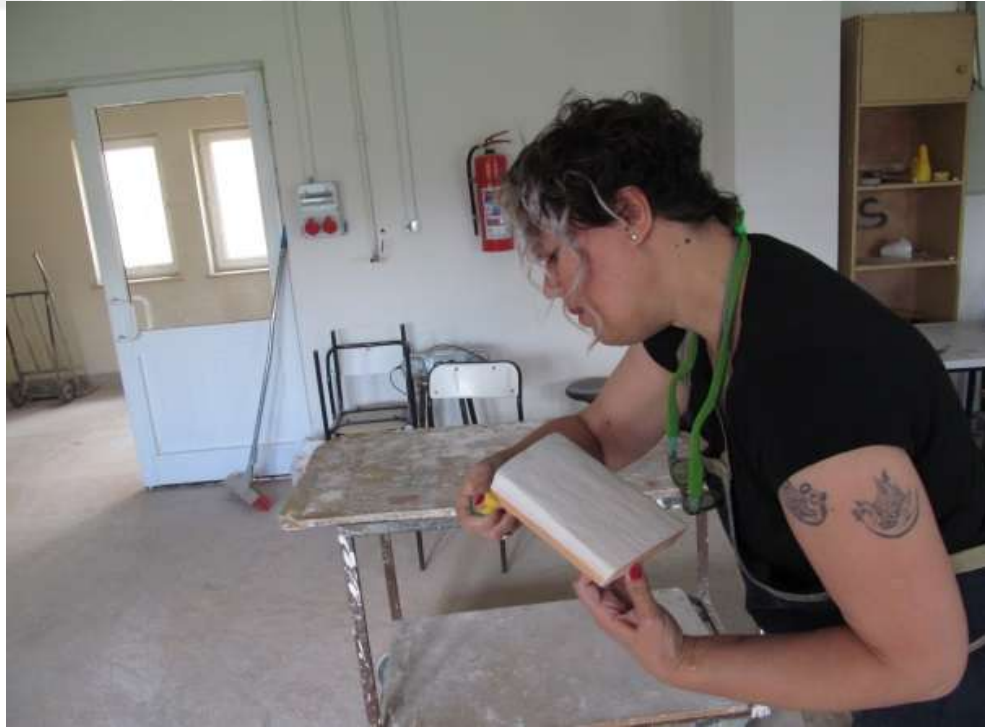
Foto 97: Sırlanan parçaların altlarının silinmesi
