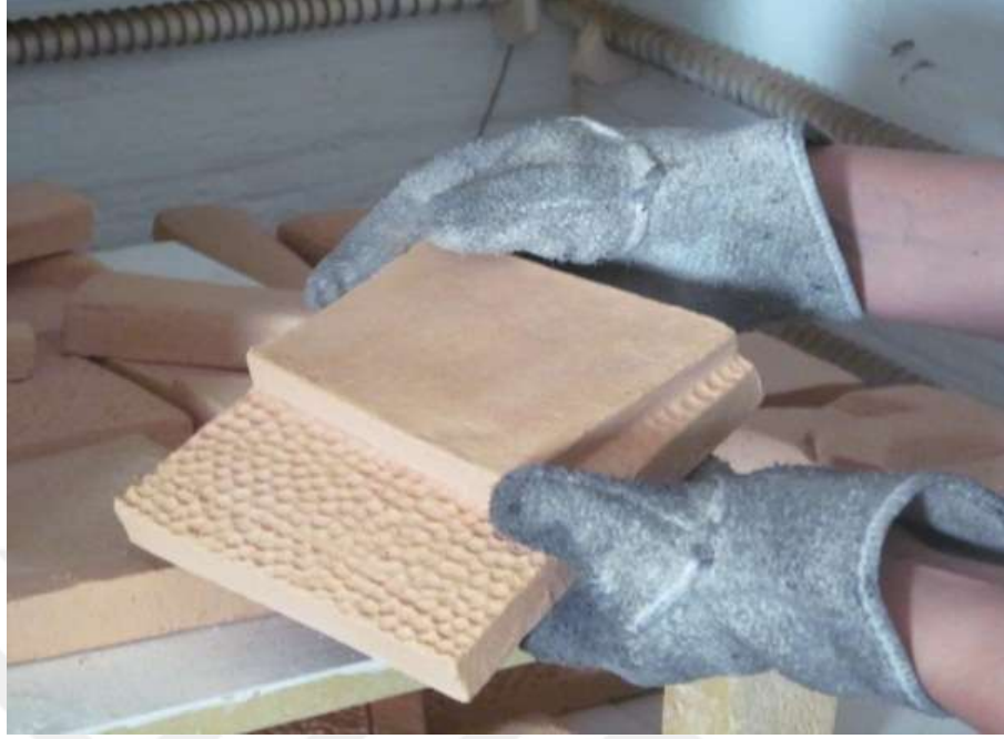
Foto 85: Bisküvi pişirimi yapılmış parçaların boşaltılması
