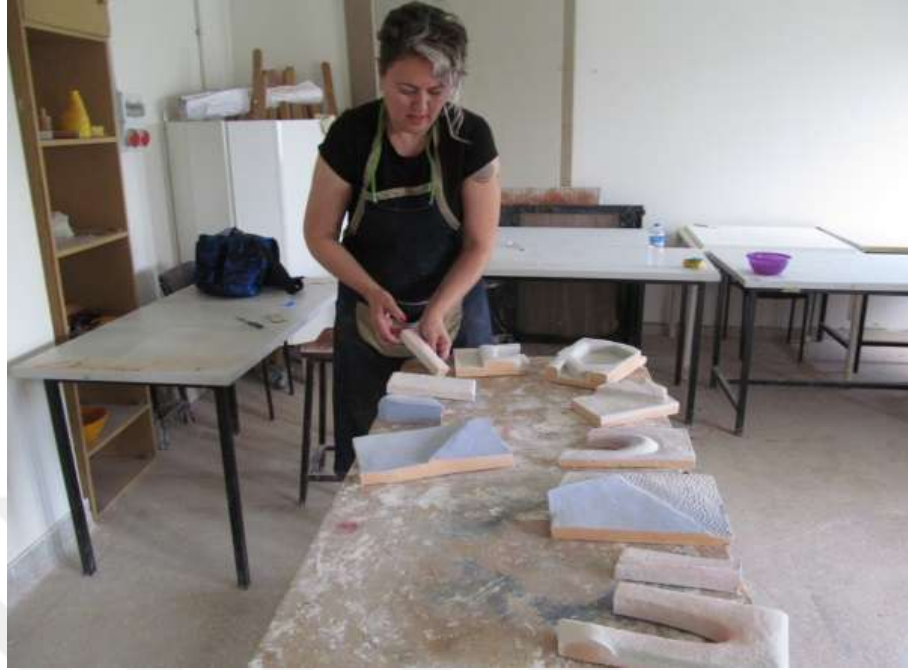
Foto 98: Sırlanan parçaların altlarının silinmesi
