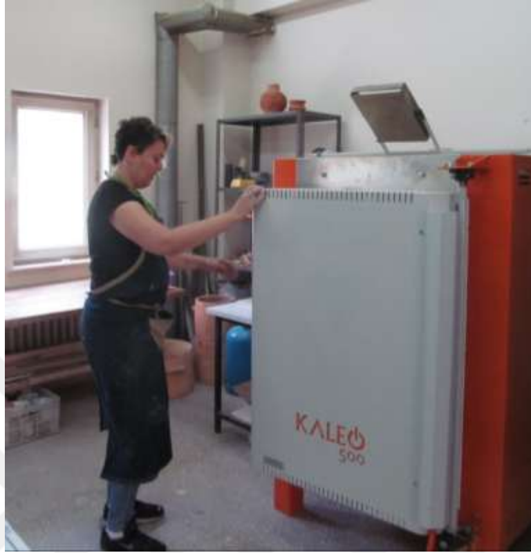
Foto 101: Sırlı pişirim için fırının son kontrolleri yapılıp çalıştırılması
