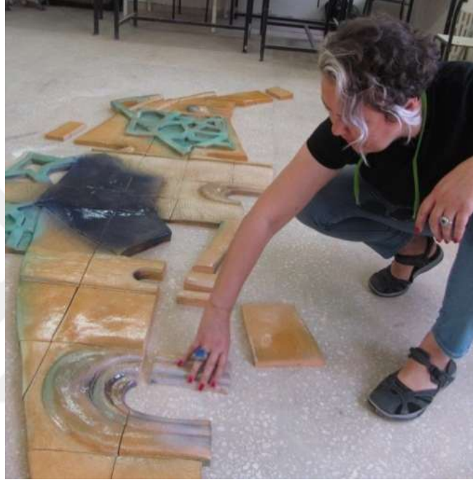
Foto 103: Sırlı pişirim sonrası pano parçalarının sır atölyesinde düzenlenmesi
