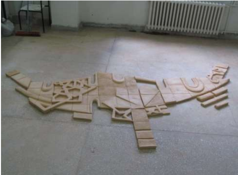
Foto 88: Bisküvi pişirimi yapılmış olan parçaların sırlanmak üzere düzenlenmesi
