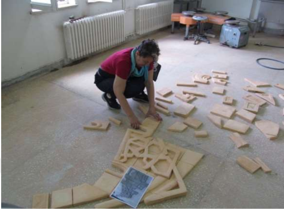
Foto 87: Bisküvi pişirimi yapılmış olan parçaların atölyede sırlanmak üzere düzenlenmesi
