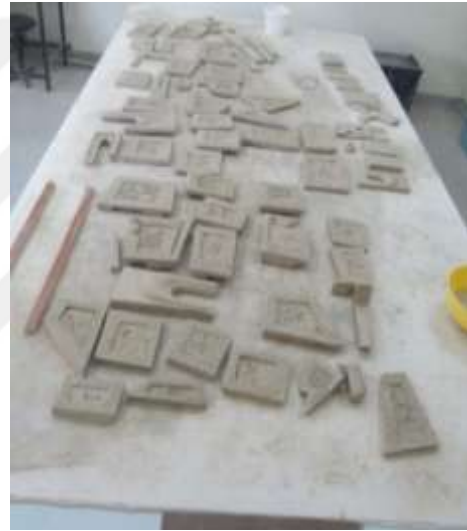
Foto 81: Pano parçalarının kuruması için ters çevrilmesi
