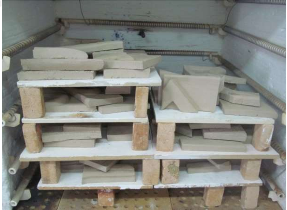
Foto 84: Kuruyan pano parçalarının fırına yerleştirilmesi
