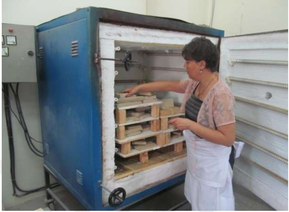
Foto 83: Kuruyan pano parçalarının fırına yerleştirilmesi
