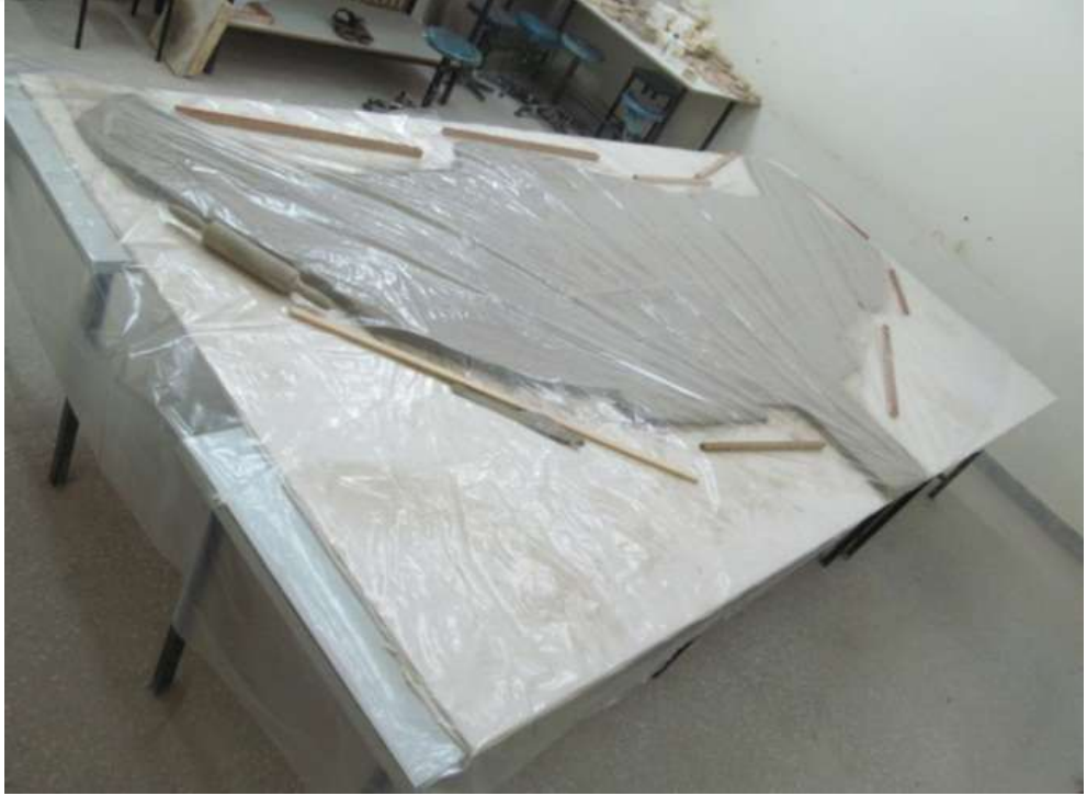
Foto 18: Seramik Panonun kurummasını engellemek için naylonla kapatılmış hali
