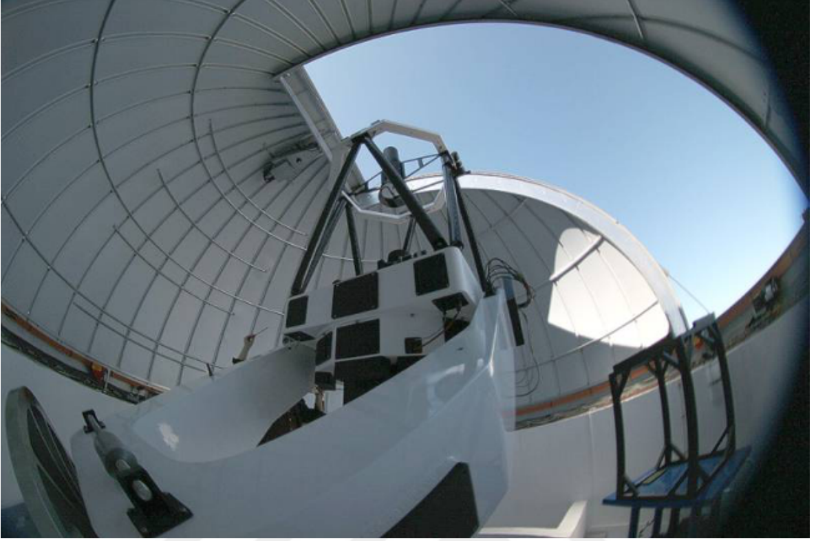
Şekil 3.1: Fotometri ve astrometri amaçlı gözlemlerde kullanılan 1.0 m ayna çaplı T100 teleskobu, TÜBİTAK Ulusal Gözlemevi/Bakırlitepe.
