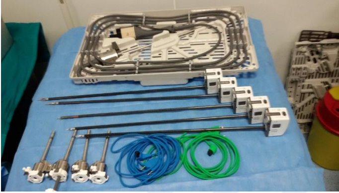
Resim 3.2: Robotik malzemeler: 4 adet 8 mm'lik metal port, robotik Prograsp forceps, robotik monopolar eğri uçlu makas, robotik maryland bipolar forceps, 2 adet robotik portegü, monopolar ve bipolar koter bağlantı kabloları, 0° Da Vinci 3DHD endoskopik optik
