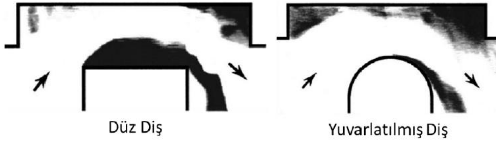
Şekil 2.17 : Yuvarlatılmış diş ve akış etkisi (Rhode ve Allen, 2001).
