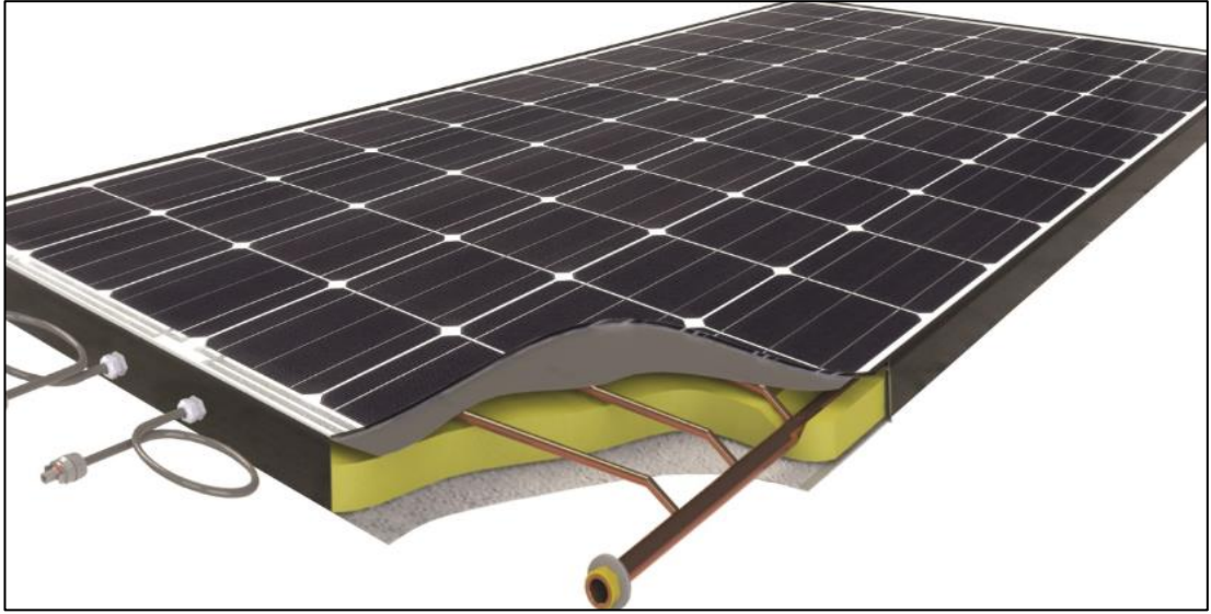
Şekil 2.20. Su soęutmalı bir PV/T sistemi [2].
