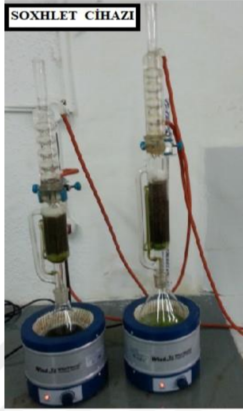
Resim 3. Bitki ekstraktı elde etmede kullanılan Soxhlet Cihazı (Foto: Yıldız ASLAN)
