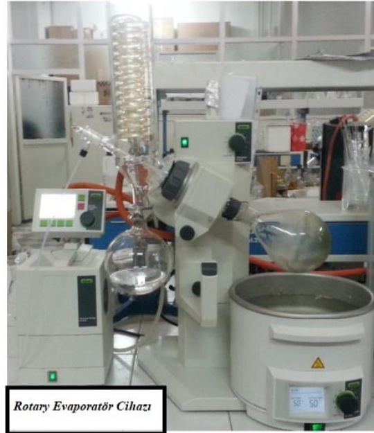
Resim 4. Çözücü uçurulmasında kullanılan Rotary Evaporatör Cihazı (Foto: Yıldız ASLAN)
