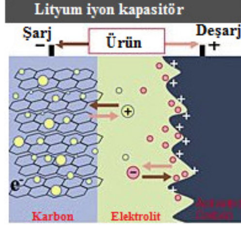
Şekil 4.29. Li-iyon kapasitörlerin yapısı.
