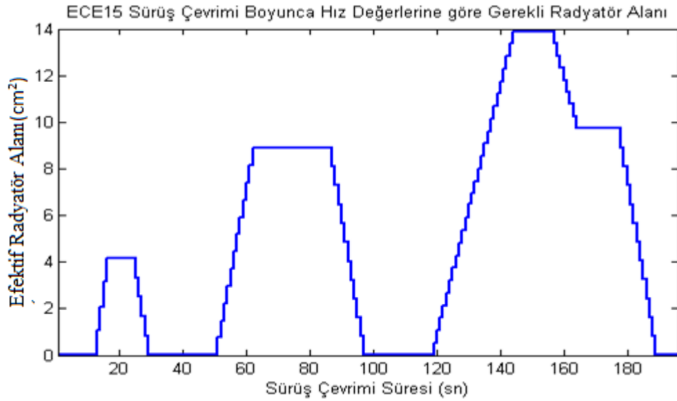
Şekil 5.14. Sistemin için gerekli radyatör alanı (cm 2 ).
