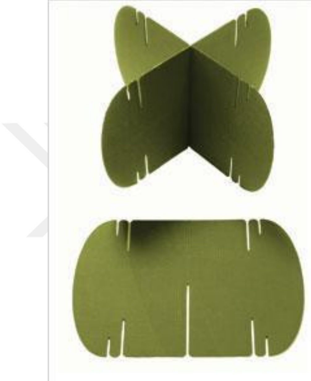
Resim 2.4.8. Mio Nomad portatif duvar panel parçası ve yapılışı
