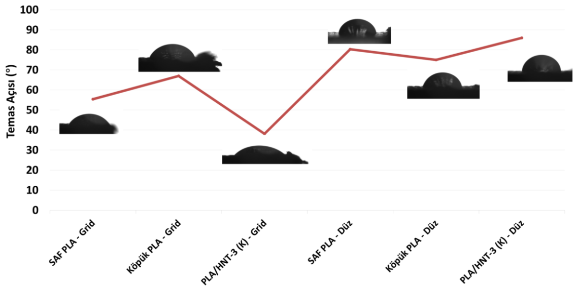
Şekil 5.37 Lazer Tekstürlenmiş Doku İskelelerinin Su Temas Açısı Ölçümleri
