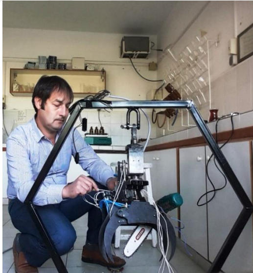
Şekil 4.39. Prototip elektrik kumanda montaj (d)
