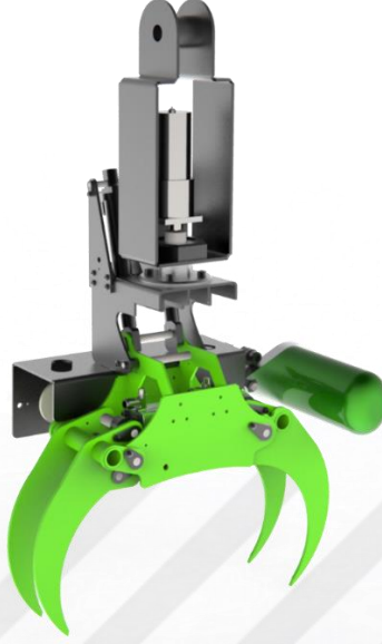
řekil 4.40. Tasarımı ve imalatı tamamlanmış budama aparatı
