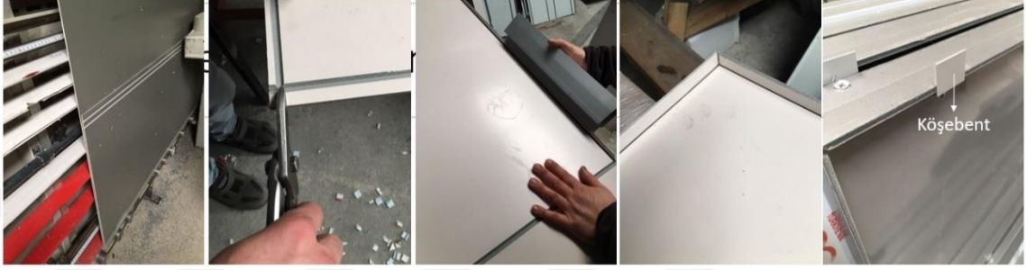
Şekil 2.71. Alüminyum kompozit panel imalatı (Anonim 2018).
