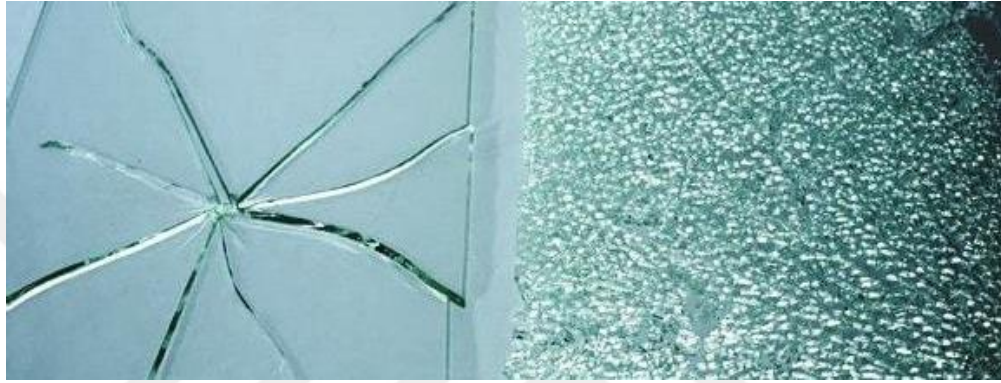
Şekil 2.52. Float cam ve temperli cam kırılma durumundaki farkları (Anonim 2019ac)
