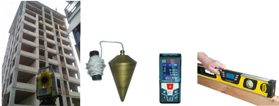
Şekil 2.64. Nivo ile şakül uygulaması, şakül, lazer metre ve su terazisi örnekleri (Anonim 2019)
