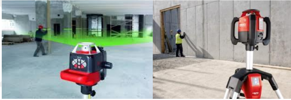
Şekil 2.63. Lazerli nivo örneği ve uygulama şekli (Anonim 2019)
