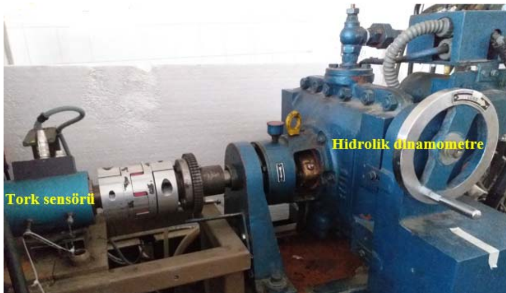
Şekil 5. Deneylerde kullanılan tork sensörü ve hidrolik dinamometre.
