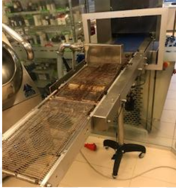
Şekil 3.1 Çikolata kaplı gofret üretiminde kullanılan kaplama ünitesi ve tünel
