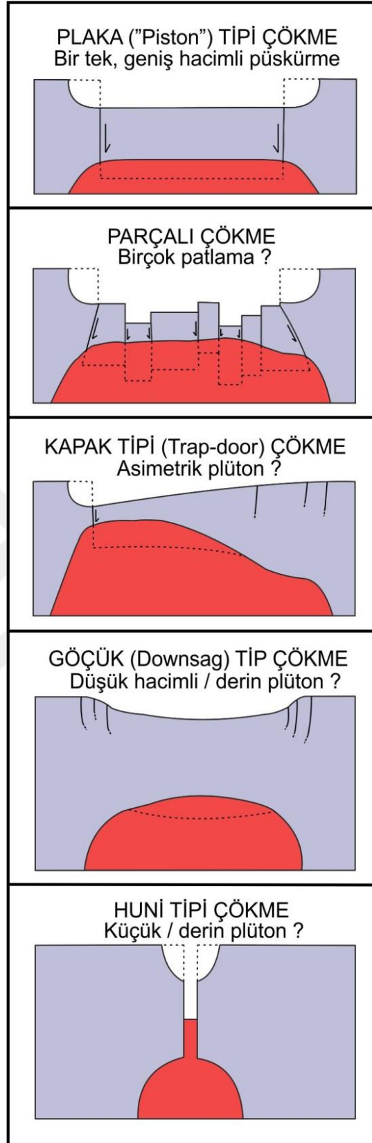
Şekil 1.2. Magma odasının geometrisi ve derinliğine bağlı olarak gelişen kaldera çökme tipleri (Lipman (1997)'den Ulusoy (2002)'nin Türkçeleştirdiği haliyle alınmıştır).
