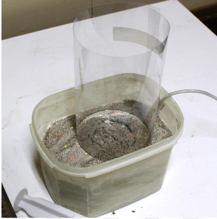
Şekil 2.19. Modele yerleştirilen 10,5 cm çaplı silindirik şekilli asetatin yerleştirilmesi.
