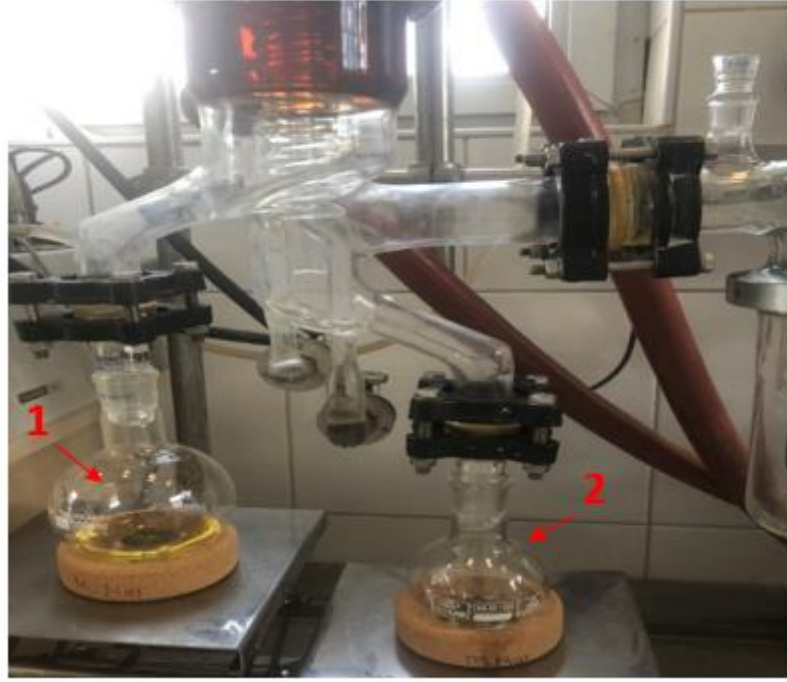
Şekil 3.2 Moleküler distilasyon cihazı ürün toplama haznesi (1: Distilat; 2: Atık)
