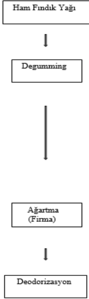
Şekil 3.3 Ön asitlik giderme işlemi uygulanmadan gerçekleştirilen fiziksel ve kimyasal rafinasyon işlem basamakları
