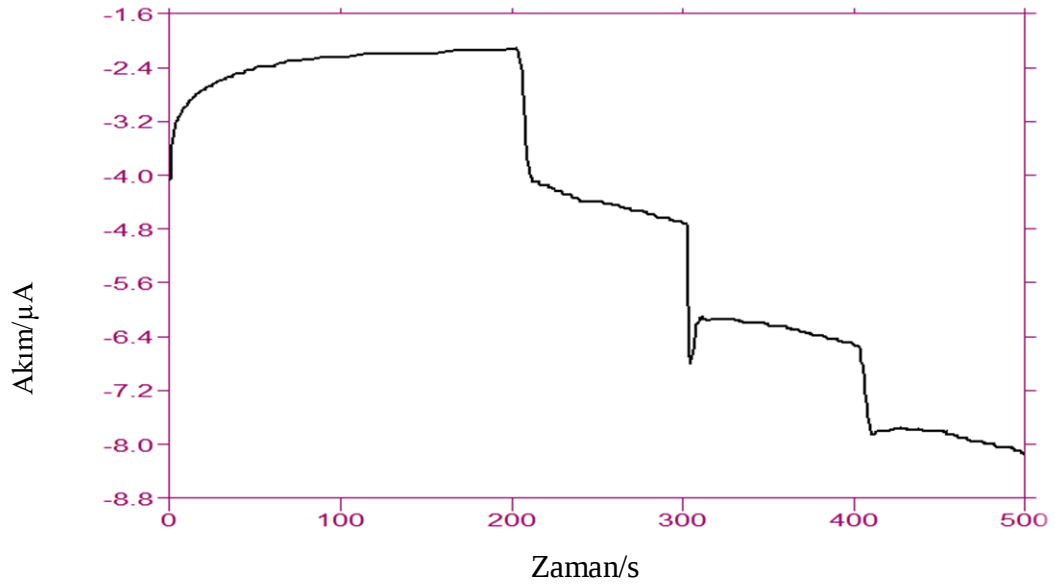
Şekil 4.39: ODPA-PI-TiO 2 kaplı Pt elektrodun glikoz enjeksiyonlarına yanıtı 850 mV/s,
