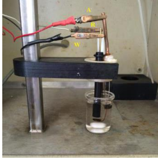
Şekil 3.2: Elektrokimyasal ölçümlerde kullanılan hücre ve elektrotlar
