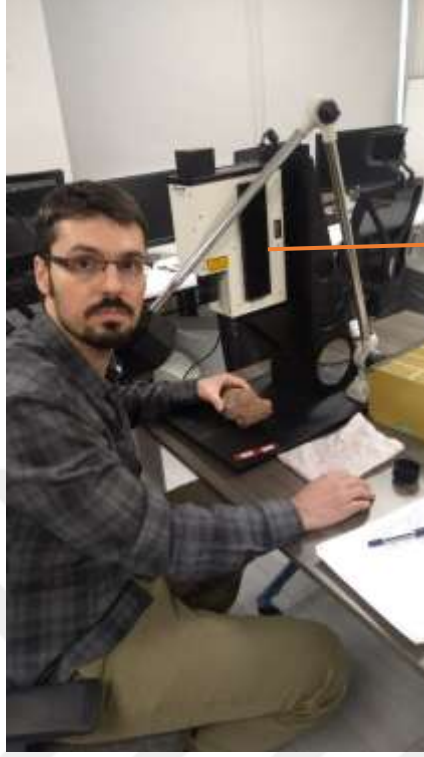
Şekil 2.1. Spectravista SVC-HR 1024i spektoradyometri
