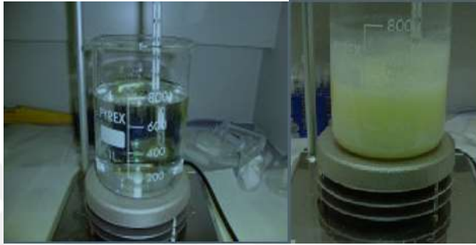
Şekil 2.4. Hidrotermal yöntemler ile HAP üretimi [18]
