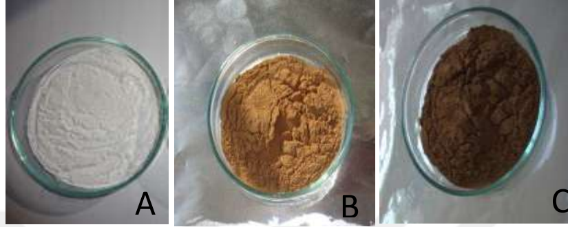
Şekil 5.1. A) hidroksiapatit toz, B) oda sıcaklığında kurutulmuş nano Ag-HAP, C) 105 °C’de kurutulmuş nano Ag-HAP
