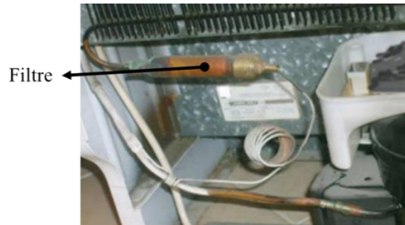
Şekil 2.7 : Buzdolabında kullanılan filtrenin montajlı hali [36].
