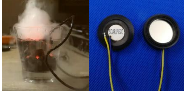
Şekil 1.20 : Suyu temas yüzeyinden buharlaştıran piezoelektrik titreştirici cihaz.
