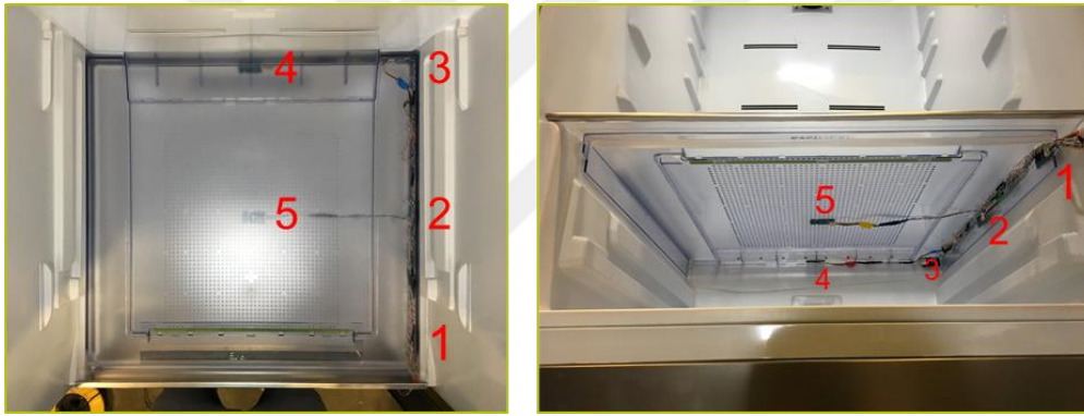
Şekil 3.16 : Öncül sensör testleri için sensör konum alternatifleri.
