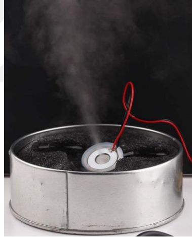
Şekil 1.19 : Suyu temas yüzeyinin diğer tarafından buharlaştıran piezoelektrik titreştirici cihaz.
