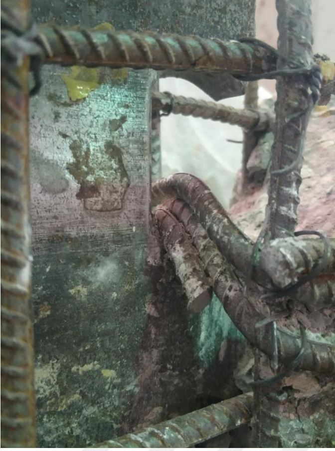
Şekil 5.37 deney sonrası donatıların deformasyonu
