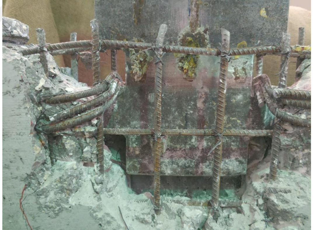
Şekil 5.36 deney sonrası donatı ve levhanın deformasyonu
