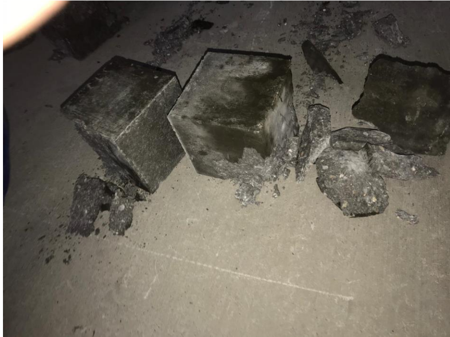
Şekil 3.1 Lifsiz beton numunelerin deneyden sonraki hali
