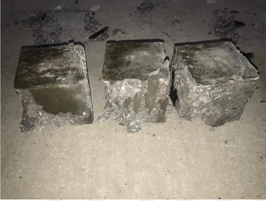
Şekil 3.2 Lifli beton numunelerin deneyden sonraki hali
