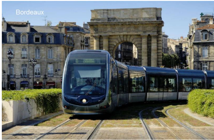
Şekil 3.4 : Alstom tarafından uygulanan APS sistemli tramvay hattı.
