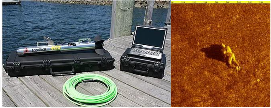
Resim 31: Berry, Mike. (2017). Side Scan Sonar Ve Sualtından Elde Edilen Görüntü, Special Search Equipment
