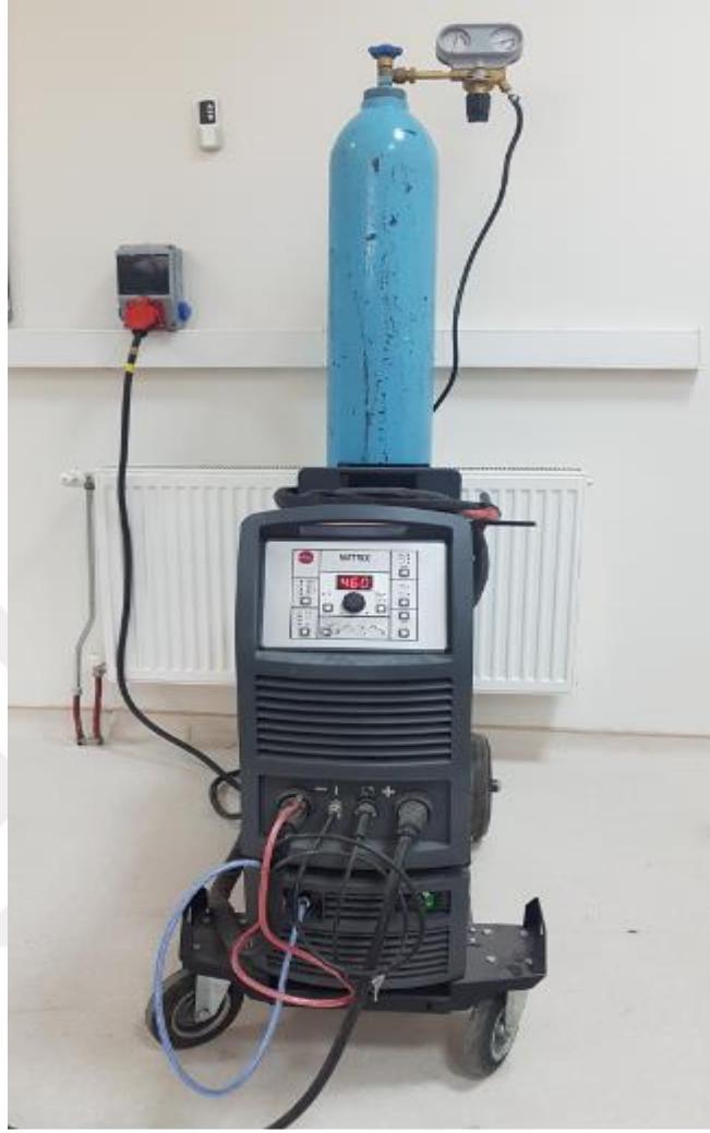
Resim 3.2 Deneylerde kullanılan TIG kaynak makinesi
