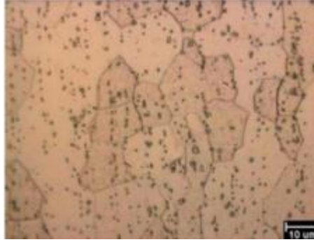
Şekil 1.30 Ferritik paslanmaz çeliğin mikroyapısı
