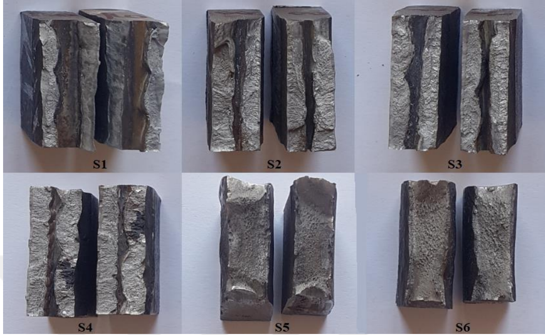
Resim 4.12 Numunelerin çekme testi sonrası kırık yüzey görüntüsü
