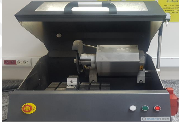
Resim 3.3 Masaüstü numune kesme cihazı
