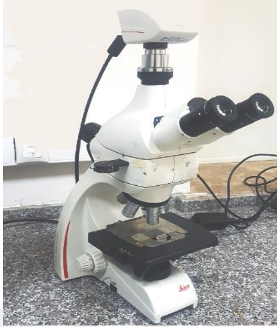
Resim 3.5 Optik mikroskop cihazı resmi
