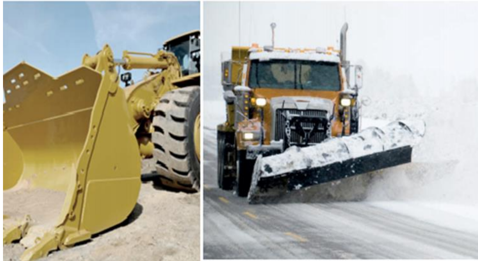
Şekil 1.34 Durostat çeliklerinin kullanıldığı bazı taşıtlar [91]
