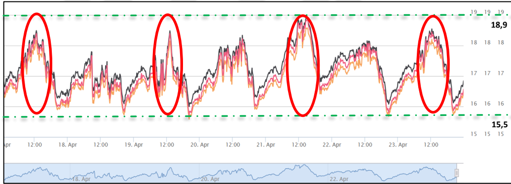
Şekil 4.2. GES1 faz nötr gerilim etkin değer değişimi analizi.
