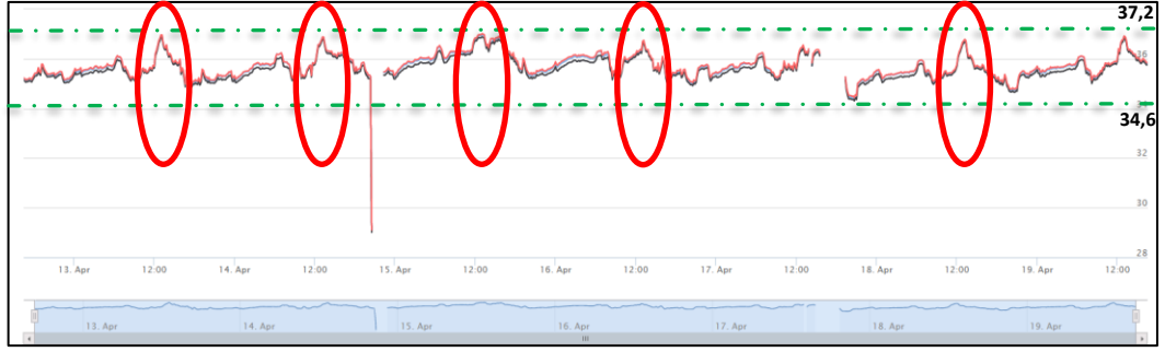
Şekil 4.7. GES4 faz faz gerilim etkin değer değişimi analizi.
