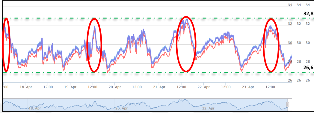
Şekil 4.1. GES1 faz faz gerilim etkin değer değişimi analizi.
