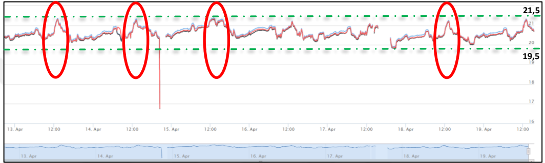
Şekil 4.8. GES4 faz nötr gerilim etkin değer değişimi analizi.
