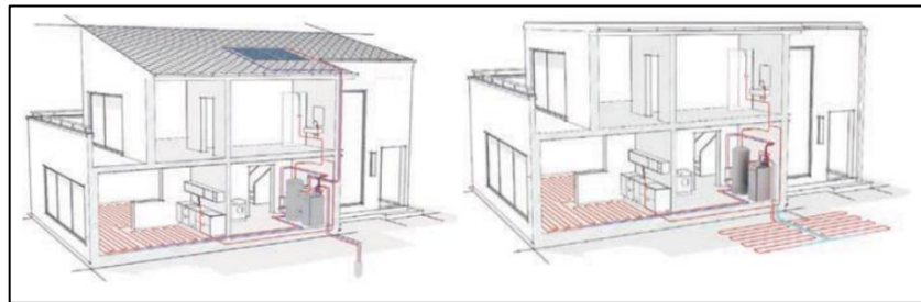
Şekil 3. 39 Dikey, yatay toprak kaynaklı ısı değiştiricisinin şematik gösterimi (Yalçınkaya, 2019)
