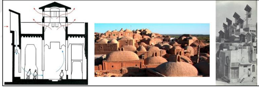
Şekil 3. 33 Rüzgâr kepçelerinin çalışma prensibi ve geleneksel rüzgâr kepçeleri (Kısa Ovalı, 2009; Sahebzadeh vd, 2017; Rudofsky,1964)
