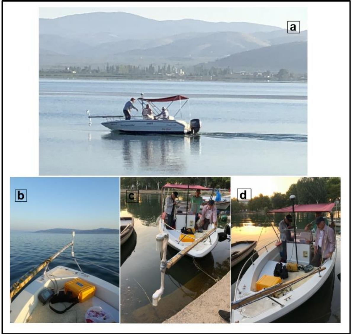
Şekil 4. 1: Geometrics G-858 Sezyum Buhar Manyetometresi ve GPS konumlandırma Sistemi a) Teknede konumlandırma şekli b) Geometrics G-858 Ekran konsolu c) Manyetik sensör d) GPS Hemisphere A101 Anten
