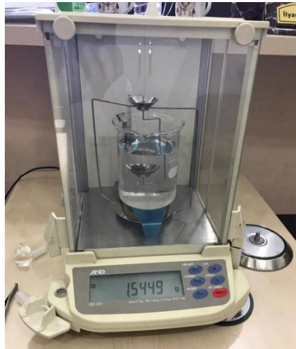
Şekil 4.12. AND / GR 200 marka hassas terazi
