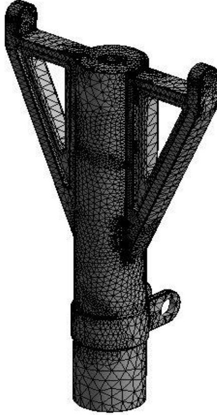
Şekil 5.5 : Ana dikme ağ yapısı.
