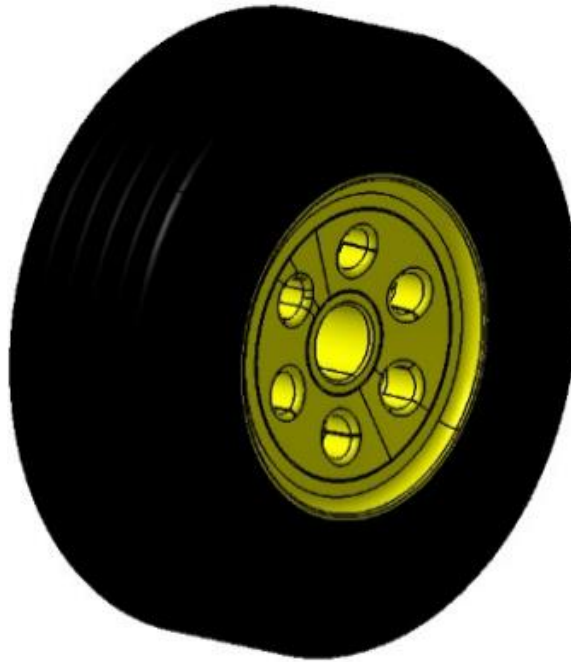
řekil 3.3 : Burun iniř takımı tekerleęi.
