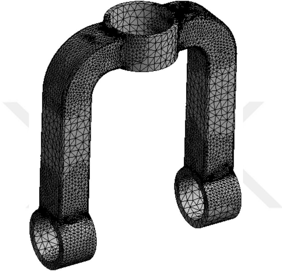
Şekil 5.3 : Burun iniş takımı çatalının ağ yapısı.
