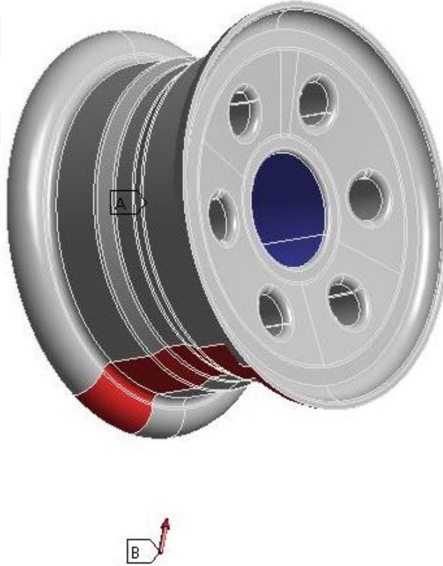
Şekil 5.6 : Jant parçasının sınır şartları.
