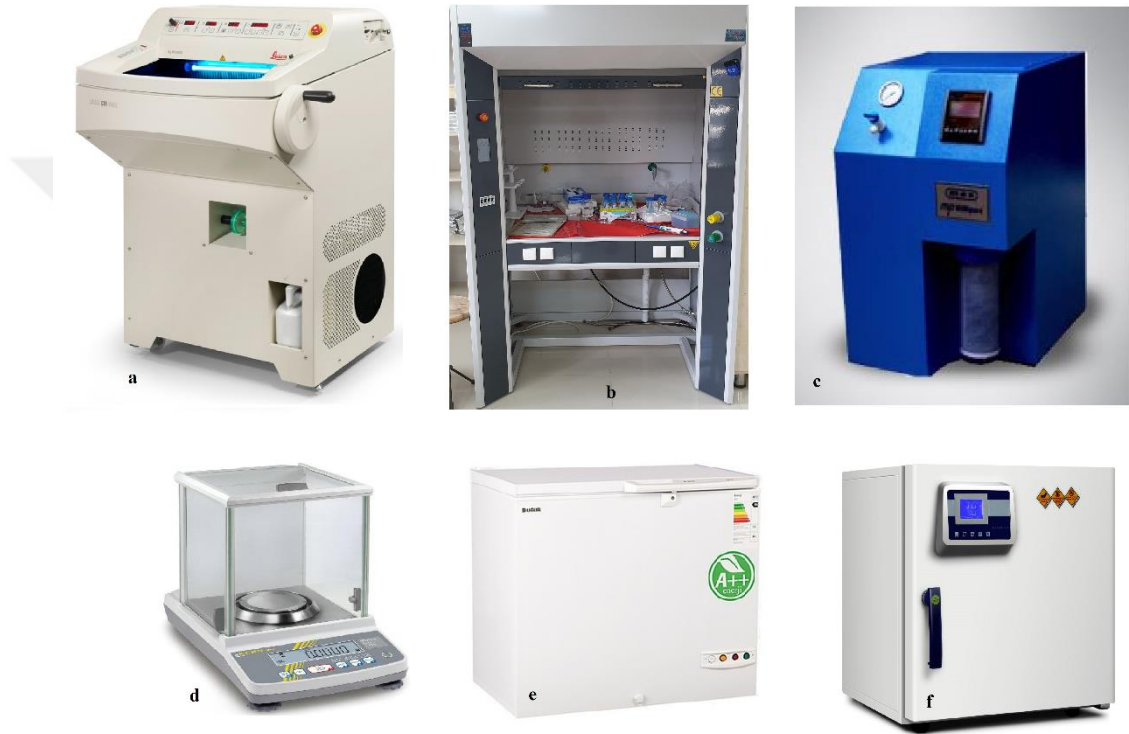
Şekil 8- Histoloji aşamasında kullanılan aletler. a- Kriyostat; b- Çeker ocak; c- Distile su cihazı; d- Hassas terazi; e- Derin dondurucu; f- Etüv
