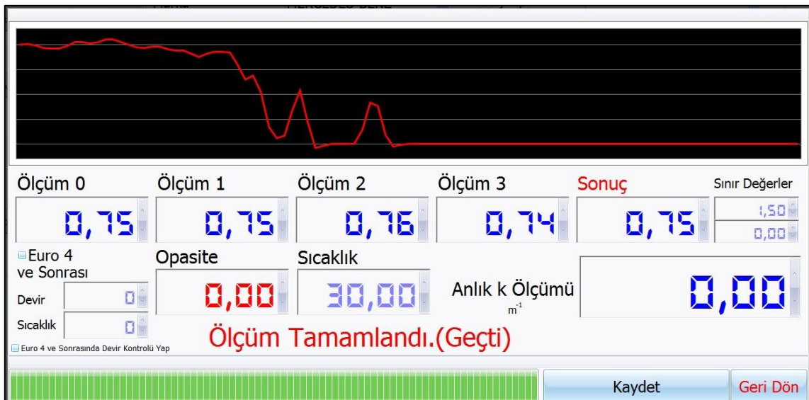
Şekil 4.13. Turbolandırılmış bağlantı emisyon ölçüm değerleri
