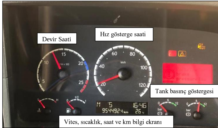
Şekil 3.14. 1250 d/dk'da ölçümler yapılırken araç gösterge paneli görüntüsü
