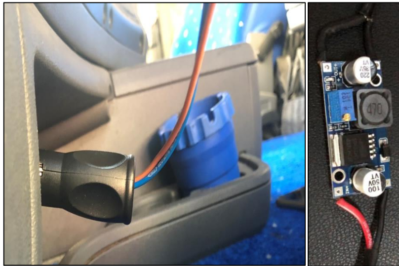
Şekil 3.8. Çakmaklık elektrik beslemesi (sol) ve regülatör (sağ)
