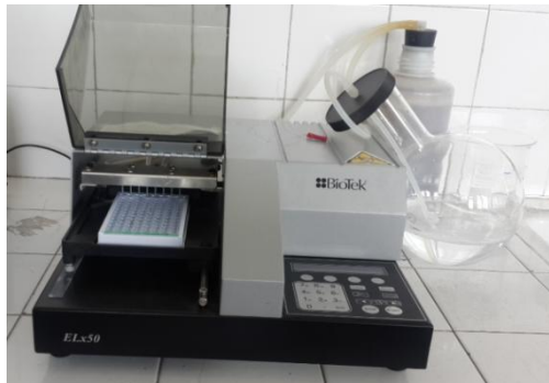
Resim 8. Yıkama işleminin yapılması
