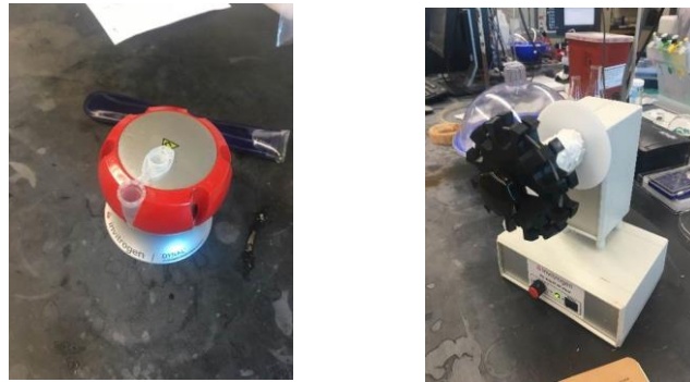
Şekil 5.13 Manyetik partikül-antikor kompleksi hazırlamak için kullanılan Invitrogen DynaMag™-Spin Magnet ve Dynabeads™ MX mikserinin görüntüsü
