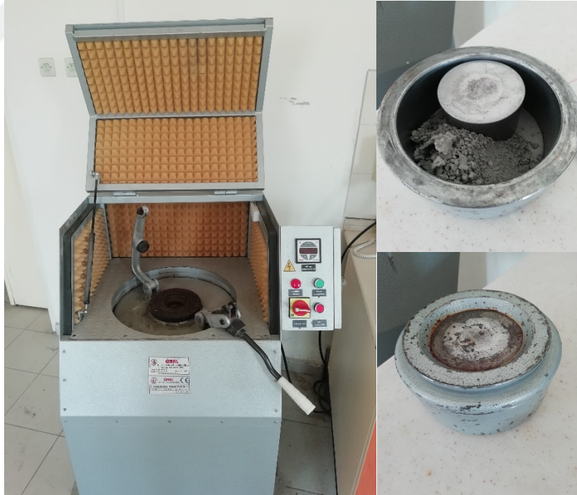
Şekil 6.2. Ünal Marka HO-1000 halkalı öğütücü cihazı
