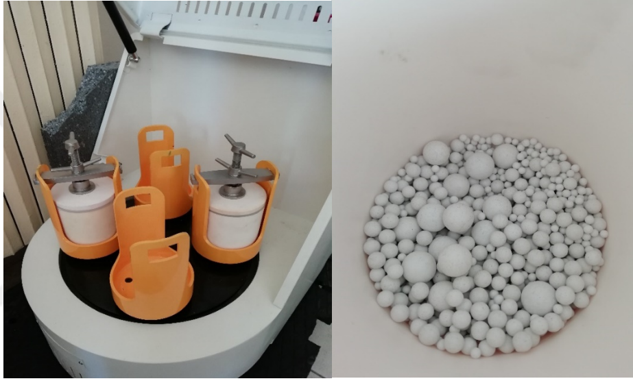
Şekil 6.5. Eksenel bilyalı değirmen ve öğütücü bilyeler
