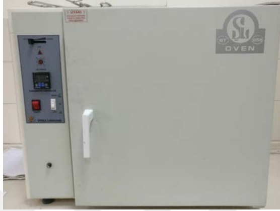
Şekil 6.8. Şimşek Laborteknik ST-055 Marka Etüvün görüntüsü
