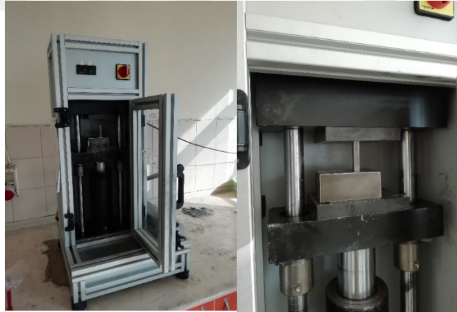
Şekil 6.11. Hidrolik pres cihazı ve işlem tatbik edilirken görüntüler
