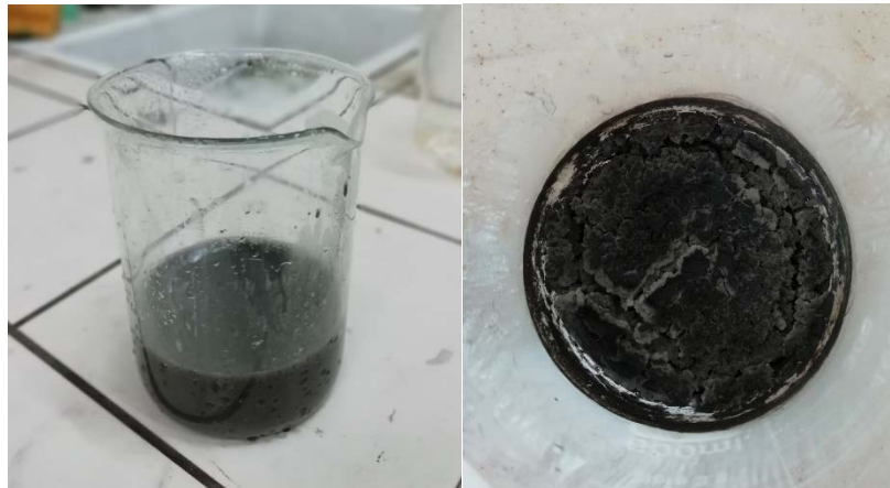
Şekil 6.9. Sulu kıvamlı karışım ve etüvden çıkan kurutulmuş numune
