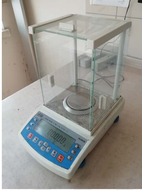
Şekil 6.6. Radwag AS 220 R2 marka hassas terazinin bir görüntüsü
